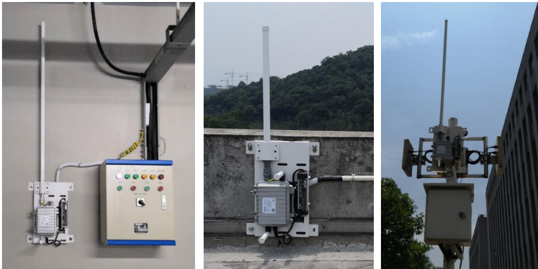
图表 7 网关室内、外安装案例
